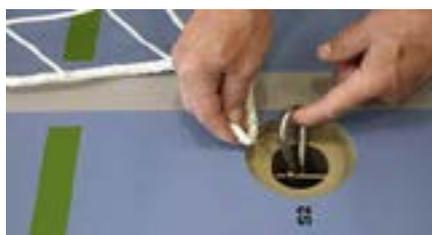
Filet et douille au sol avec mousqueton intérieur
