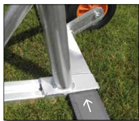
Gegengewicht wird in den Bodenrahmen eingeschoben.
